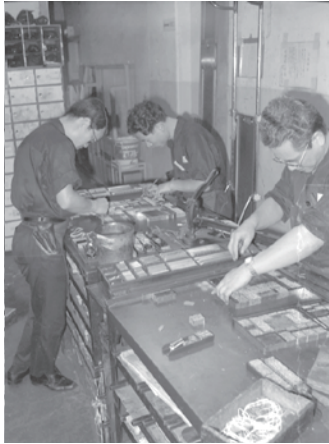
大組の準備をする作業者
